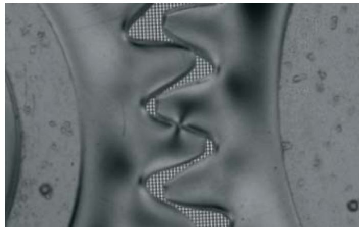
Rys. 3. Rozkład naprężeń przy styku jednoparowym Fig. 3. Internal stress pattern for a single contact
