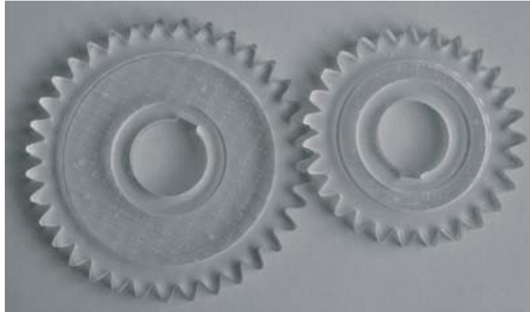
Rys. 2. Stereolitograficzne modele kół zębatych przekładni Fig. 2. Stereolithography models of gears
